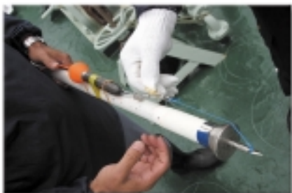
写真1：突きん棒型の竿にセットした記録装置
