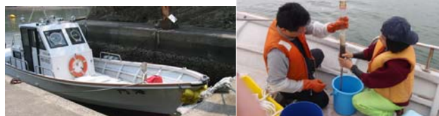
写真1. 調査船「海門」で、松島湾の海底から泥を採集
