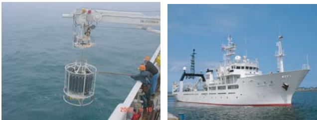
図2 調査船でのCTDによる海洋観測(左)と若鷹丸(右)
