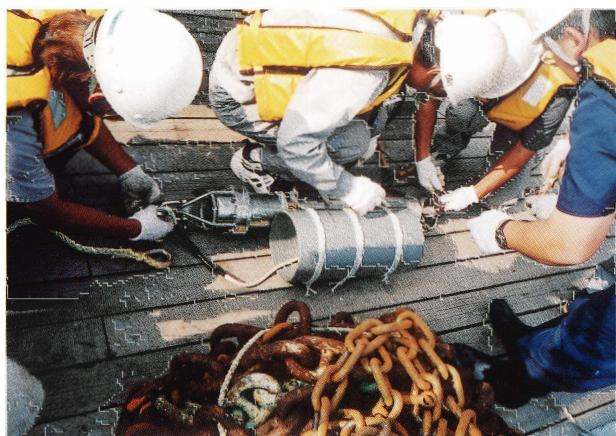
写真1 切離装置に塩ビ管を装着しているところ
