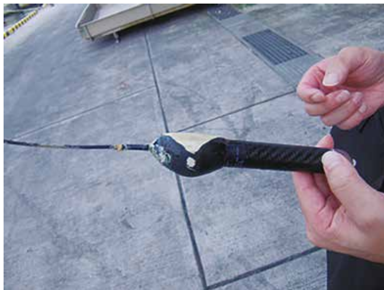
図3. 銚子で回収された Microwave Telemetry 社の PAT。PAT の一部が割れて灰色の浮力体断面が露出している。
