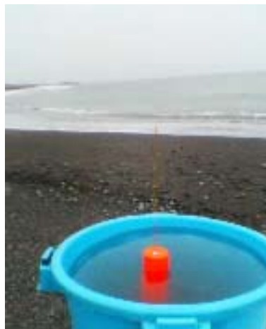
図 4. バケツの海水中の送信機。上に伸びたアンテナは非常に細くて見えにくい
