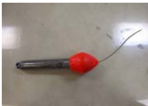
図 1. PAT タグ（本体、アンテナとも長さ約 17cm）
