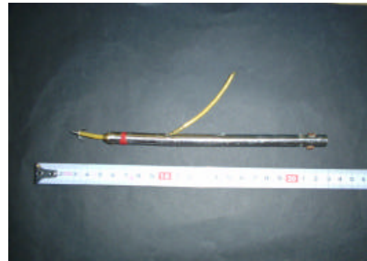
図 2. 改良したダートタグとパイプ タグの芯はステンレス部品に、パイプもステンレス丸棒を切削したものに替えて安定に装着できるようになった。このパイプを竿の先端に縛り付けて使用した。
