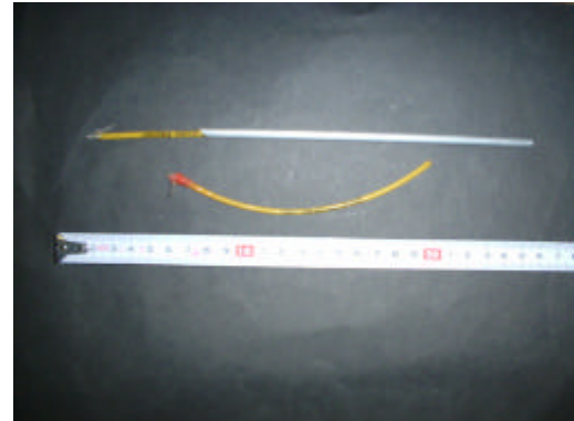
図 1. 初めに使ったダートタグとパイプ カエシの接合部は、糸やステンレスワイヤで補強したが、パイプの断面によって切断された。パイプも肉薄でつぶれ易かった。
