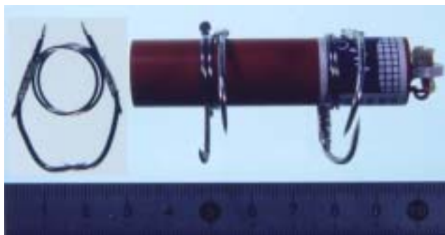
図2. 超音波発信機と取付金具（釣り針とバネの組み合わせ）
