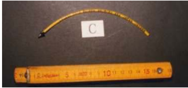
図2. 小型歯くじらに用いた改良型ダートタグ (先端をステンレス製に取り替えて補強)
