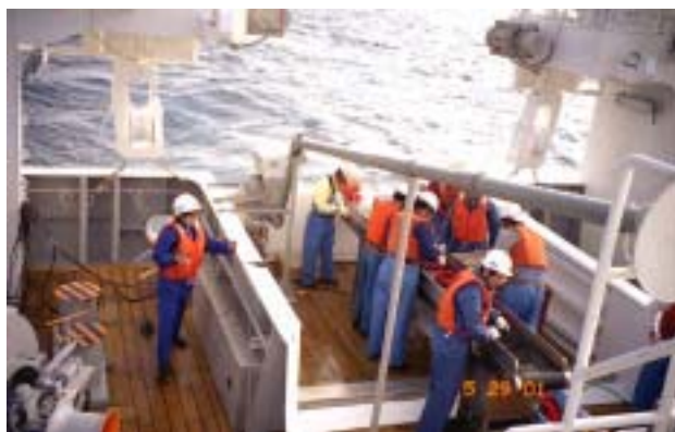
写真4. 延縄操業の投縄作業 延縄操業による調査では、トロール用のスリップウェイがカバーされ、投縄用コンベアーが設置される。
