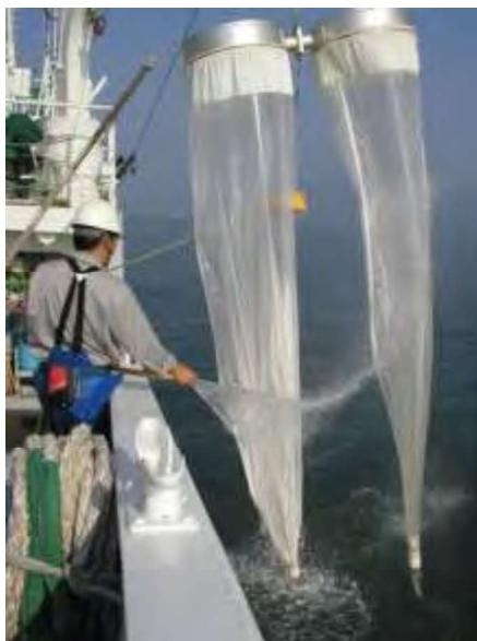
写真2. 引き上げたボンゴネットに海水をかけて採集したプランクトンを集める作業
