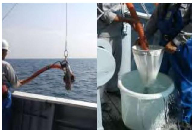
写真1. 左：水中ポンプの垂下作業 右：プランクトンネットによる浮遊幼生試料の採取
