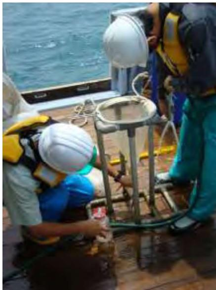
写真3. 集めたプランクトンを濃縮してサンプル瓶に入れる作業
