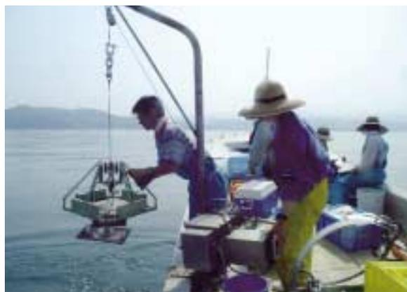
写真1 スミス・マッキンタイヤー型採泥器による底泥採取
