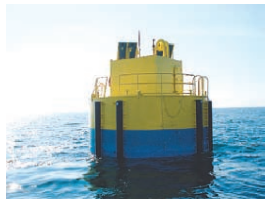
写真1. 沖合養殖用集中管理自動給餌ブイ。ディーゼル発電と太陽光パネルで稼働。
