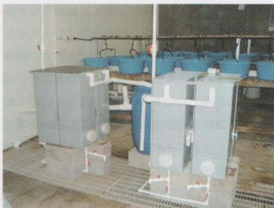
写真6. タスマニア大学水産増養殖研（TAFI）で使われている四連接型のイセエビ幼生飼育水槽。左がニュージーランドで考案されたオリジナルで、右がオーストラリアで改良したもの。
