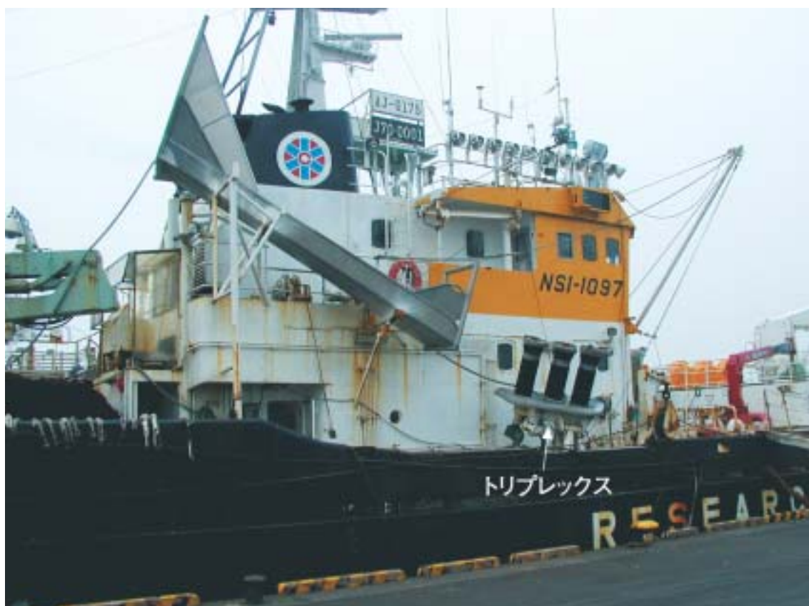
写真1 トリプレックスとその設置位置。トリプレックスは船体右舷中央付近に設置してある。（平成丸）
