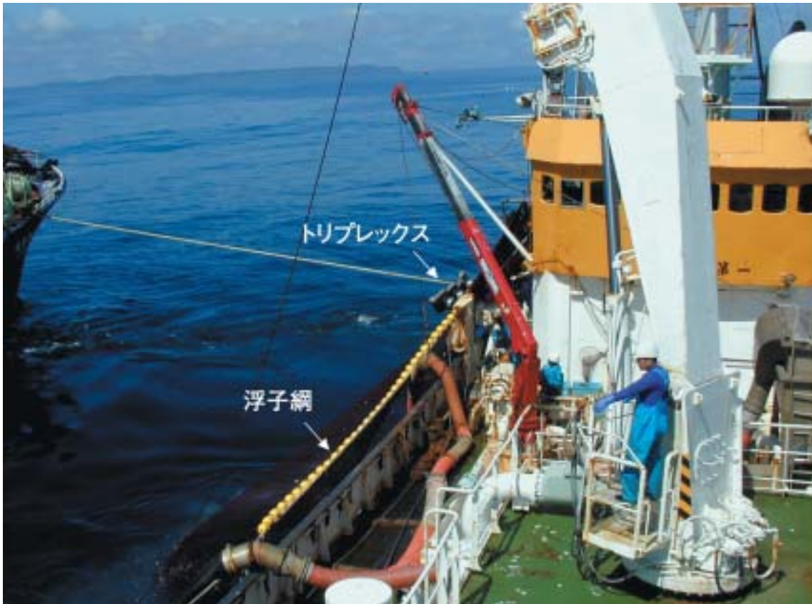
写真2 揚網終了時、舷側に網丈の浅い魚捕が袋状に形成される。沈子網は、舷側に張り渡したワイヤーに吊り下げてある。サイドローラーによる網起こしが必要ないためデッキ上に漁網が見られない。(平成丸)
