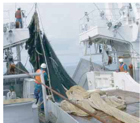
図4 開洋丸による夏季ベーリング海沖合調査 さけ・ます類を漁獲するための表層トロール網を船尾より投入しているところ。
