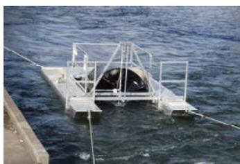
図2 ロータリー式スクリーントラップ
