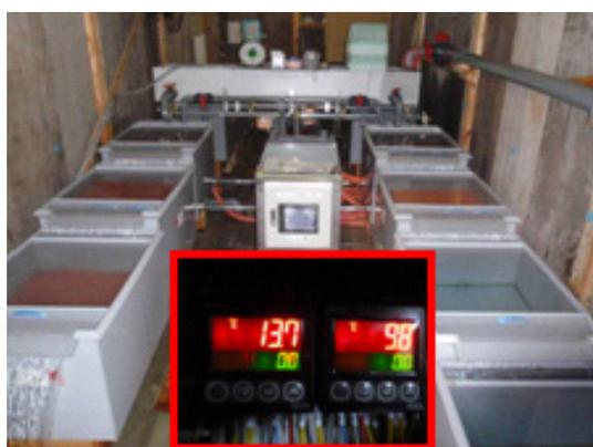
図2 耳石温度標識装置（2機設置）及び温度表示版（源水温11.8℃に対し、±2℃で加温（右）と冷却（左））
