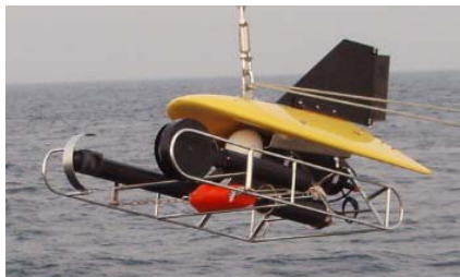
図2 Visual Plankton Recorder 前面右側(円形ホイール)がストロボ、左側がレンズ
