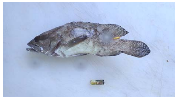
写真 産卵後のナミハタと小型深度・水温記録計。記録計のサイズは、長さ3cm、重さ6g。
