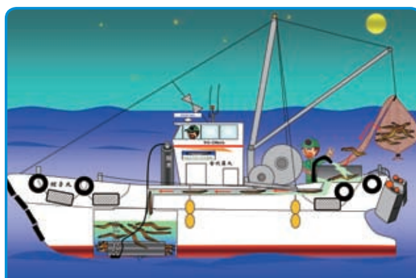
図1 徳島の漁師さんが開発したハモの擦れを防ぐ素麺流し。塩ビパイプの中をハモが流し素麺のように流れていく（経費は2～3万円）。生け簀に酸素やブローを送り，活力を保つ。
