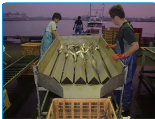
図1 徳島の漁師さんが開発したハモの擦れを防ぐ素麺流し。塩ビパイプの中をハモが流し素麺のように流れていく（経費は2～3万円）。生け簀に酸素やブローを送り，活力を保つ。
