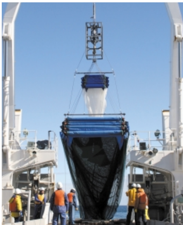
写真3：RMTマルチネット（リモートコントロールで任意の3層でサンプリングができる）によるサンプリング
