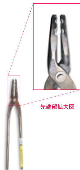
図1. 新開発した海亀用釣針外し器。
