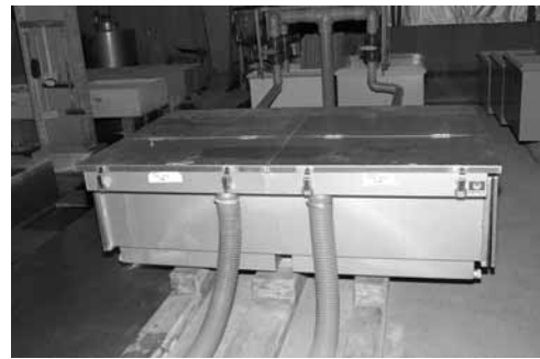
図4. 浮上槽. 受精後に卵を収容し, 浮上まで管理することが可能である.
