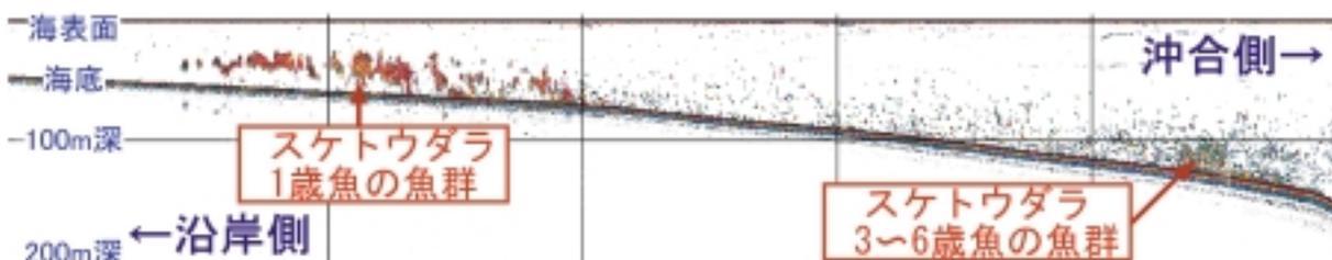
図1. 2001年6月の白糠沖におけるスケトウダラの魚群反応図。魚の反応が小さいところは青や緑で、反応の大きいところは赤で示される。
