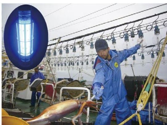
写真1. 従来の金属ハライド灯とLED水中灯（円内）。
