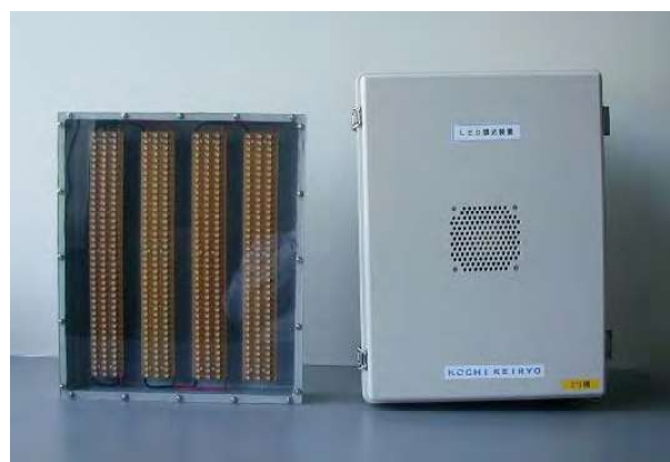
写真1 カンパチ親魚の早期採卵試験に用いた照明装置 光源部（左）と調光装置（右）
