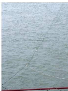
写真3. 航行中の洪湖号（左）と曳航中の水中マイクロホンケーブル（右）。白い点はケーブルを浮かせるための浮力材。
