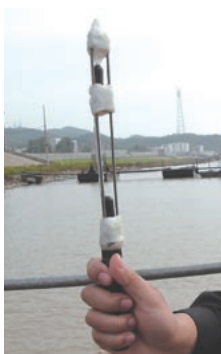
写真4. 音響モニターを続ける調査員（左）と音響データロガーと呼ばれる録音装置（右）。片手でもてるほど小さい装置で、すべてのデータが手のひらに収まっている本体部分に記録されます。内蔵電池で連続40時間観測できます。
