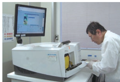
写真2. クロマグロ全ゲノム解読に用いる次世代高速シーケンサー（東京大学大学院新領域創成科学研究科）。
