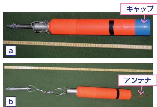
写真2. ツチクジラ用のデータロガーを納めたダーツ。 a: 発射時の形。銚先はダーツに取り付けられ、アンテナは後部のキャップに収められています。 b: クジラに曳航されるとき、銚先からダーツがワイヤーで曳航され、アンテナが伸びます。
