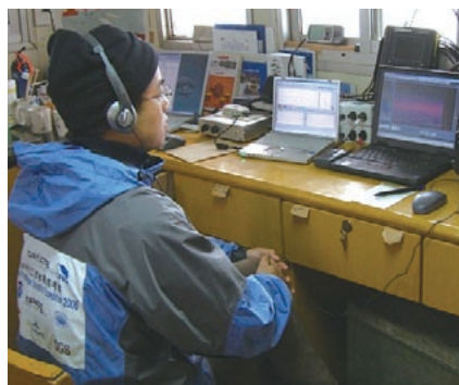
写真4. 音響モニターを続ける調査員（左）と音響データロガーと呼ばれる録音装置（右）。片手でもてるほど小さい装置で、すべてのデータが手のひらに収まっている本体部分に記録されます。内蔵電池で連続40時間観測できます。
