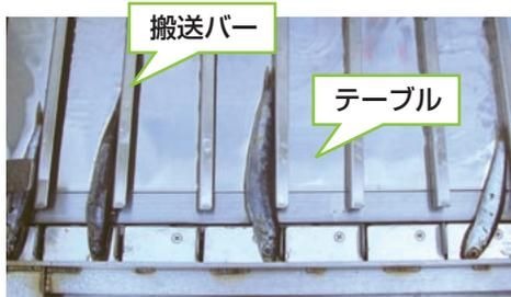
写真2: パーコンベア方式の搬送方法。
