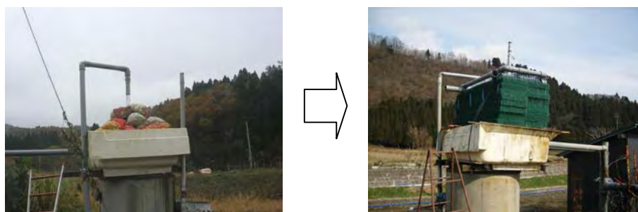
図 1. バッキ装置の改良
