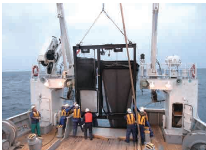
写真 2. 環境センサー付プランクトン採集システム
