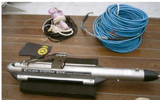
写真1 サイドスキャンソナーの曳航体（長さ 約40cm） 左右に音波の送受波器がある。
