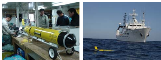
写真1. 左：水中グライダー（海中中の水温、塩分、溶存酸素、クロロフィル濃度を観測） 右：潜行直前の水中グライダーと調査船「若鷹丸」
