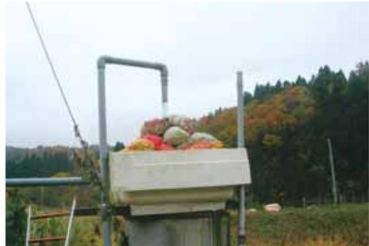
写真2 変更前の曝気(ばっき)装置
