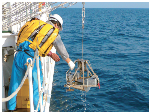
図2 スミス・マッキンタイア型採泥器による採泥作業
