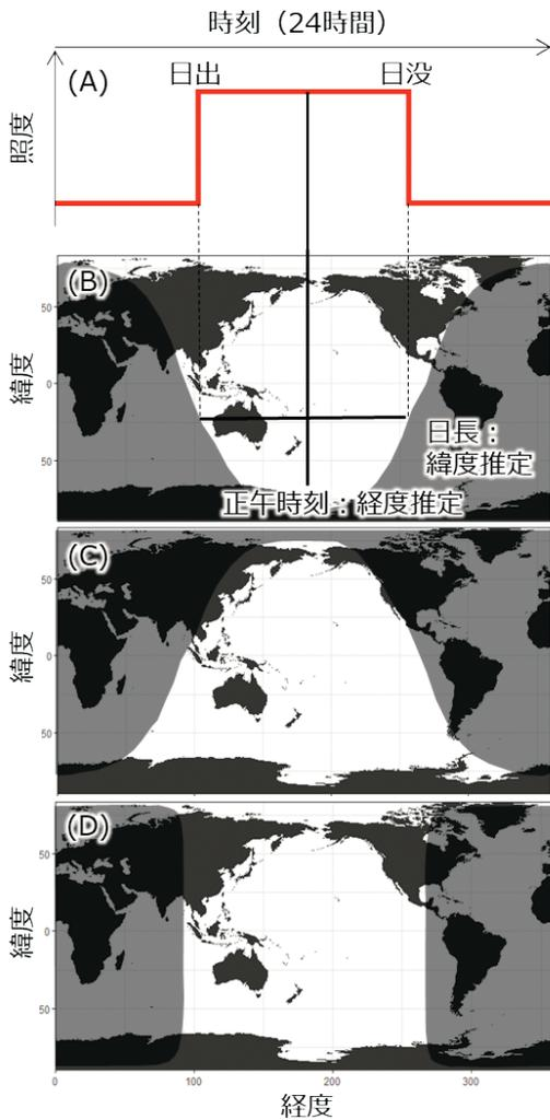
図2. 照度データから位置を推定するための模式図
