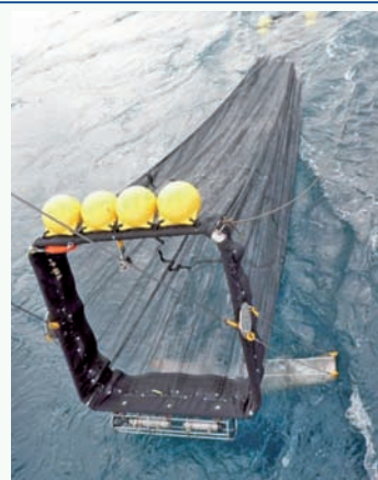
図1 コッドエンド開閉型層別採集ネット
