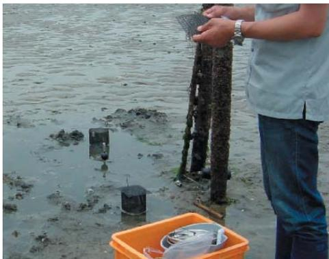
図1. 実験に使用したケージ(円柱状)及び流速計。ケージの中に測定し個体識別したアサリを入れ、各干潟で2週間飼育した。
