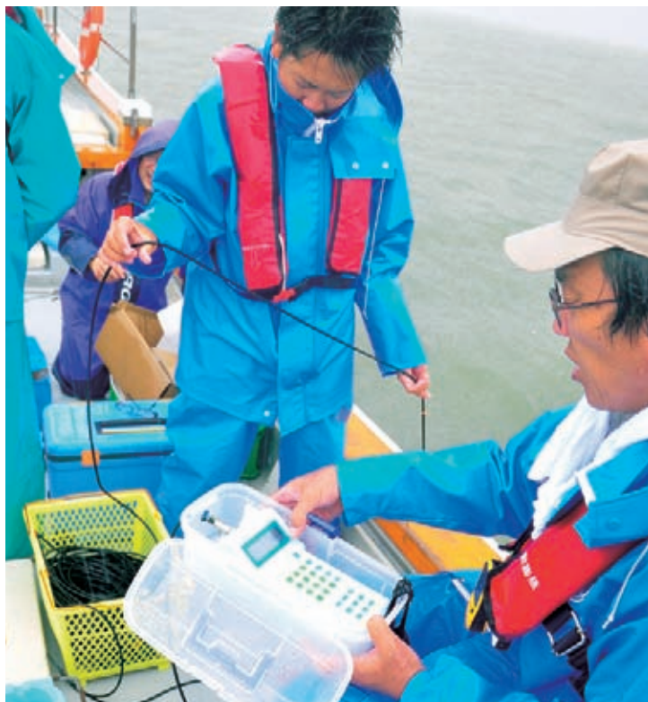
西海区水産研究所 有明海・八代海漁場環境研究センターの調査船で。 多項目水質計を海中に入れて測定します
