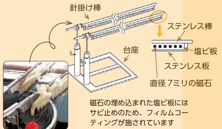
磁石の埋め込まれた塩ビ板にはサビ止めのため、フィルムコーティングが施されています
