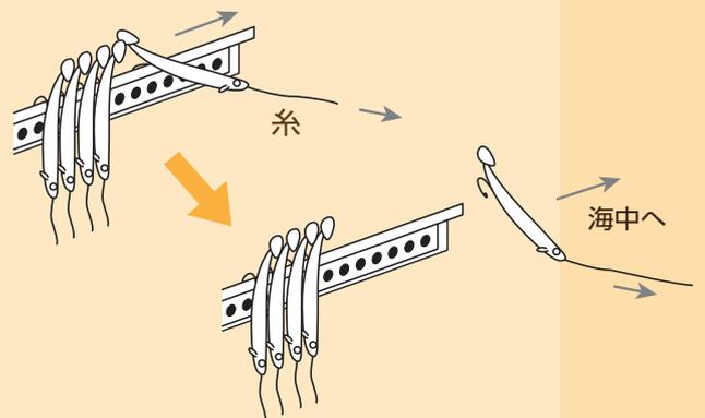
仕掛けを海中に投入すると、残りの仕掛けが糸にひかれ、セットした新擬似餌が自然に繰り出されます
