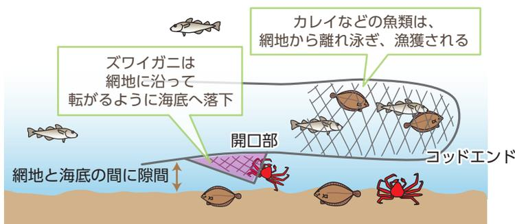
選別網などの仕切り構造はなく、コッドエンド直前に配した開口部上を漁獲物が通過する際に、遊泳性のないズワイガニが自然落下する仕組み
