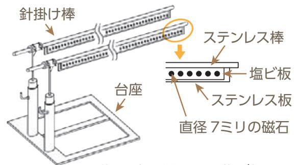
磁石の埋め込まれた塩ビ板にはサビ止めのため、フィルムコーティングが施されています
