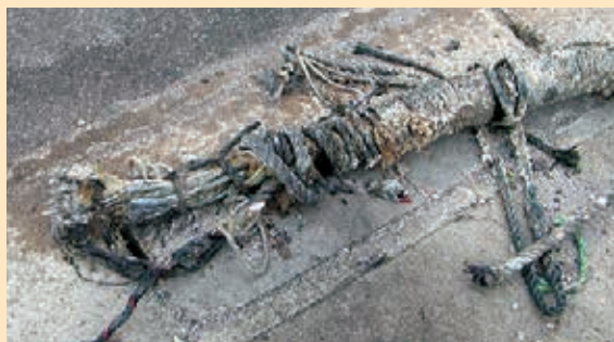
写真1. 急潮で切れた直径36ミリのワイヤー（2004年8月）
