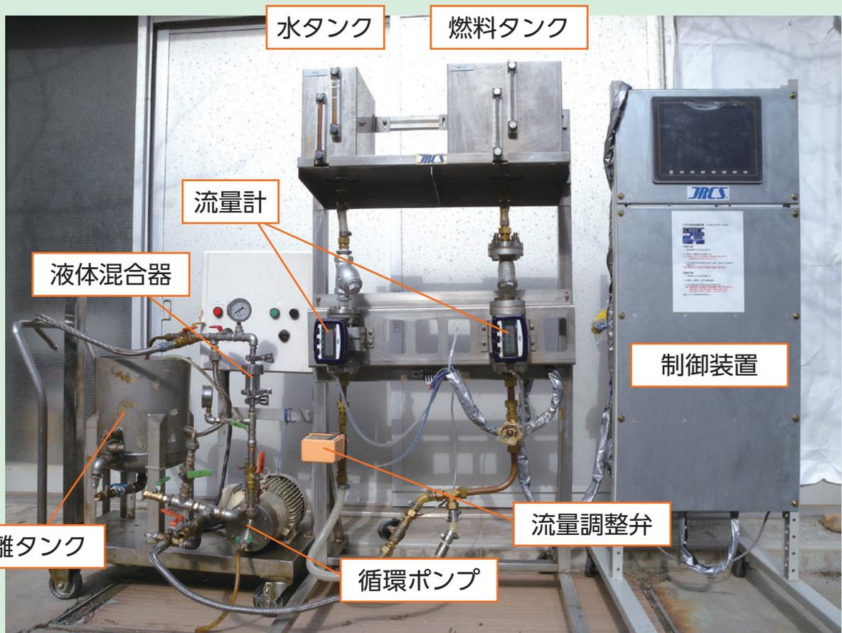
写真 油水混合装置
