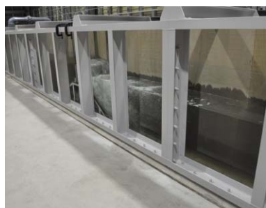
写真 1 津波実験水路
