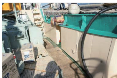
写真3 複板化ブルワーク （135トン型まき網漁船）
