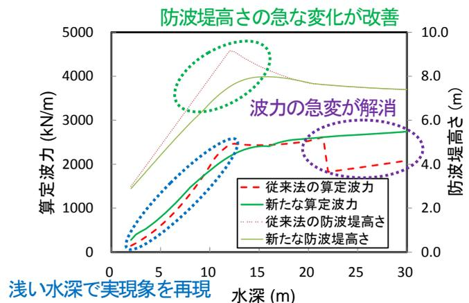
図2 標準の高さの防波堤に作用する波力の試算例
