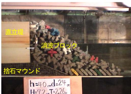
図1 消波工付き防波堤の実験模型
