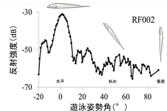
図1 タチウオの反射特性パターン
