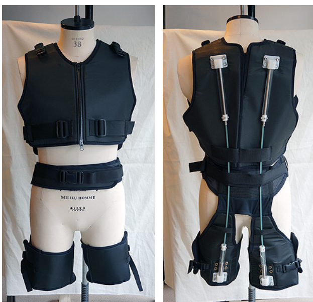
図 軽労化支援スーツ(左:前面, 右:背面)。 背部に 2 本の S-FRP を装着している。
