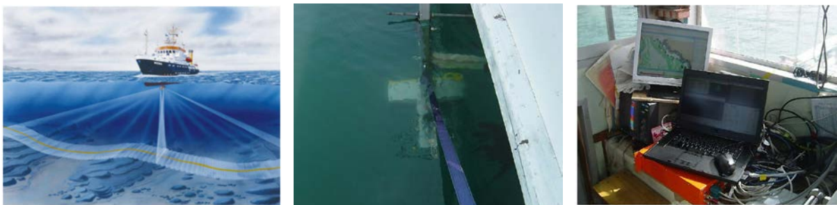
図1 マルチビーム測深機の原理(左、ATLAS HYDROGRAPHIC より)と設置状況(中:送受波器、右:ブリッジ)
