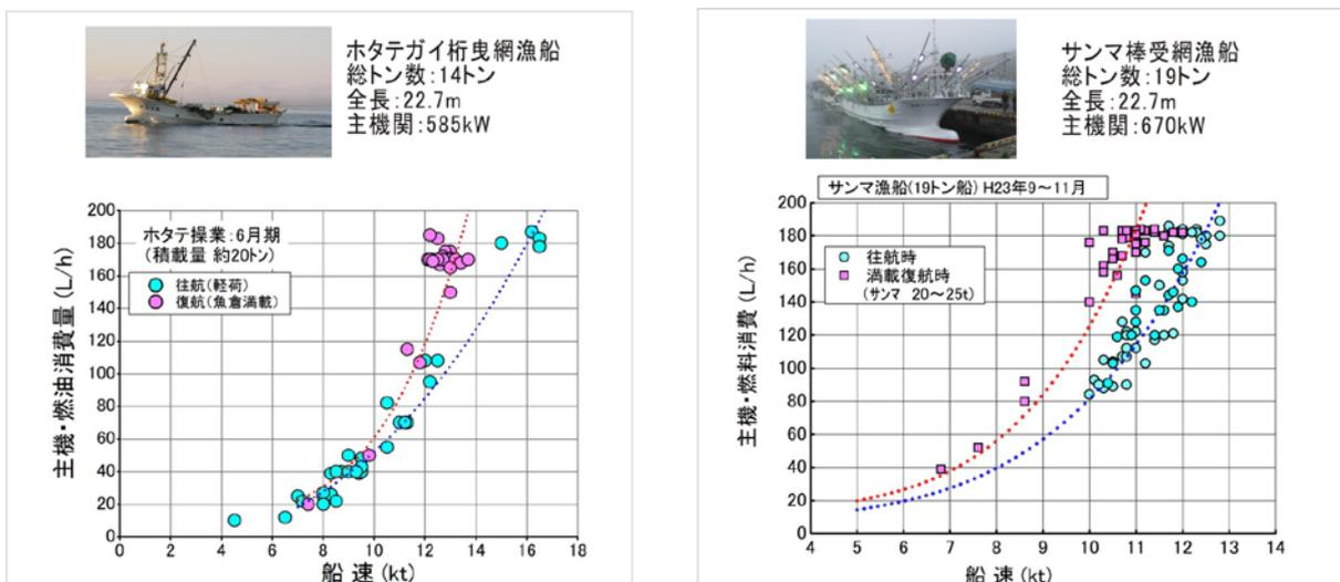
図1 ホタテ漁船およびサンマ棒受網漁船の燃料消費特性
