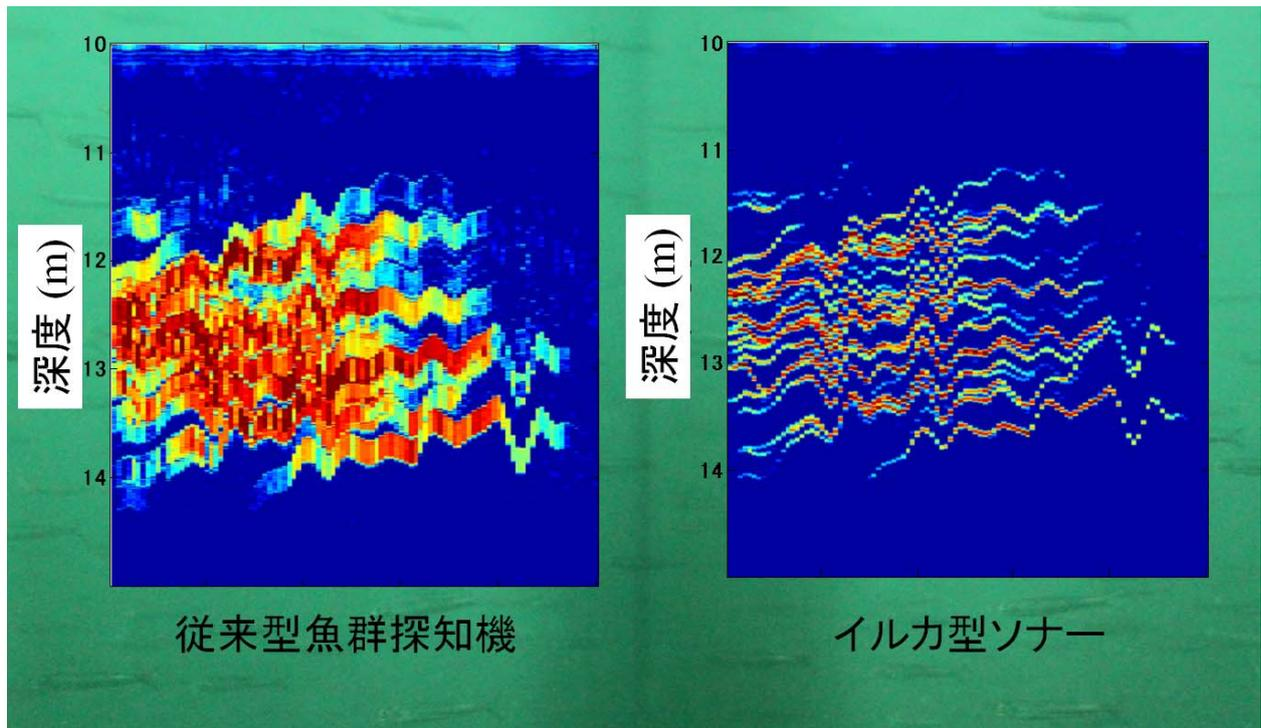
従来型に比べ圧倒的に高精細なイルカ型ソナーによる館山沖のカタクチイワシの観測例。密な群れの中でも、魚が一尾ずつ見える。背景はステレオカメラによる水中映像。
