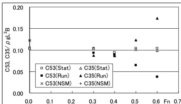
図の横軸はフルード数,縦軸は各復原力係数である。白抜き記号は静止状態で計測した復原力係数を,黒塗りの記号は航走状態で計測された復原力係数を示しており,\*印はストリップ法の推定値である。フルード数の増加に対して,復原力係数が大きく変化しており,特に左下図の連成復原力係数について,その傾向は顕著に見られる。
