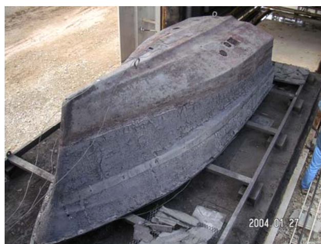
FRP 漁船の炭化処理（左：炭化前、右：炭化後）
